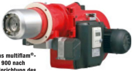
**Der Zweistoffbrenner WM-GL 10 rundet das multiflam®-Programm mit einer Leistung von 125 bis 900 nach unten hin ab. Die neu entwickelte Mischeinrichtung des WM-GL 10 multiflam® nutzt das gleiche Prinzip der Brennstoffaufteilung wie die Grossbrenner von Weishaupt. (Fotos: Weishaupt)**
