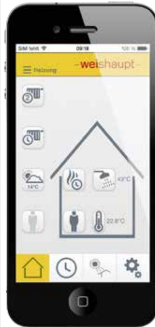
Startseite der App «Weishaupt Heizungssteuerung» Darstellung der wichtigsten Werte auf der Startseite.
