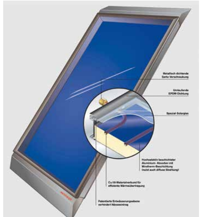
Schnittbild des eingesetzten Gas-Brennwertgeräts Weishaupt Thermo Condens. Schnittbild: Weishaupt-Solarkollektor WTS-F1 (Indach).
