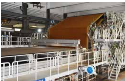
Ohne Dampf kann auf der Maschine kein Papier hergestellt werden. Gut sichtbar die Papierbahn, die slalomartig über die Trockenzylinder geführt wird.
