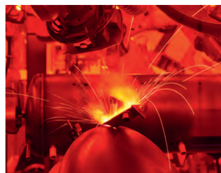
Produktionsstätte Pyropac AG im St.Gallischen Sennwald: Der Schweissroboter bei der Arbeit. (Bild: Weishaupt)
