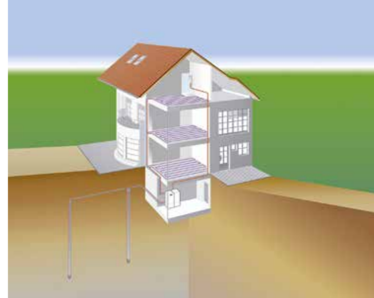
Beispiel für eine Sole/Wasser-Wärmepumpe mit Erdsonden.
