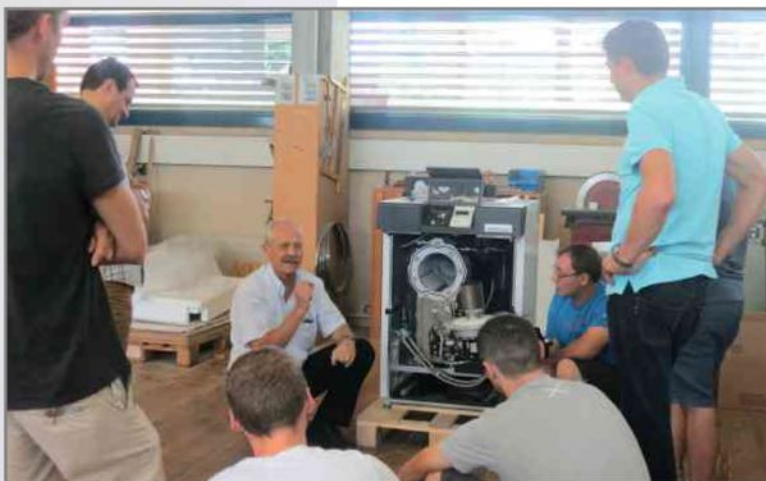
Martin Rast erklärt einer Gruppe die Demontage der Wassertasche an einem Öl-Brennwertgerät WTC-OB.
