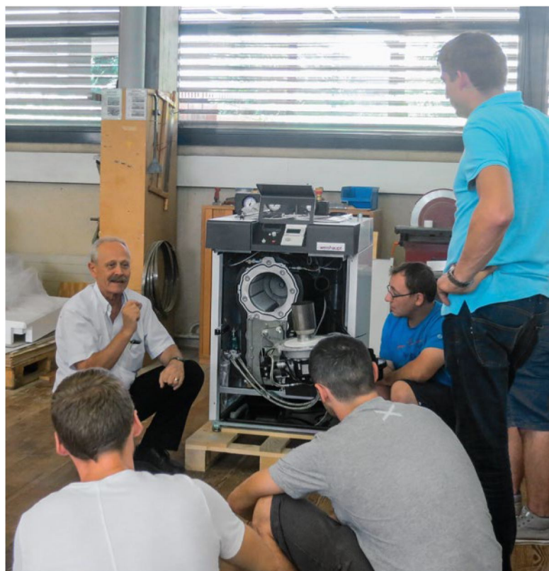
Schulungsleiter Martin Rast erklärt einer Gruppe die Demontage der Wassertasche an einem Öl-Brennwertgerät WTC-OB.
