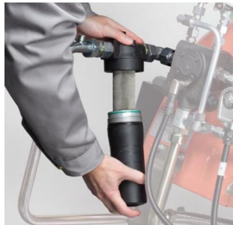
*Der integrierte Ölfilter ist leicht zugänglich (bei MS Brenner Ausführung unterschiedlicher MFO-Brennstoffe im Wechselbetrieb serienmäßig)*
