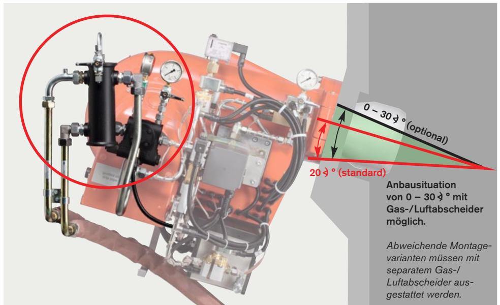
Montagefertige Umbausätze erleichtern die Umrüstung eines vorhandenen Brenners und sind zeitsparend (Beispiel RMS7 / RMS8)
