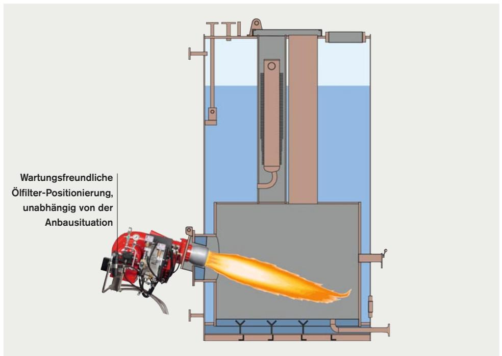
Mit dem MS Umbausatz (Beispiel MS7 / MS8) lassen sich Anbausituationen von horizontal bis vertikal lösen
