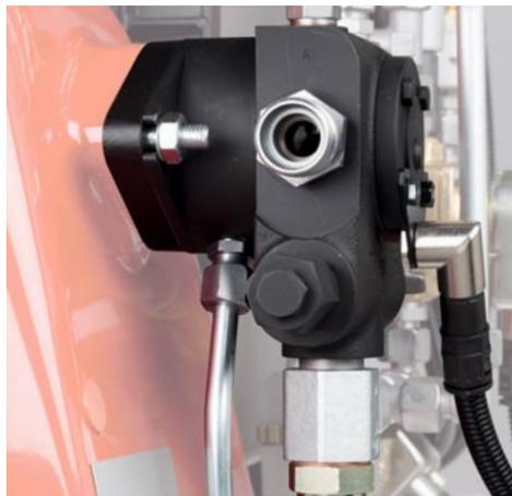
*Durch eine gezielte Leckageableitung wird ein Höchstmaß an Sicherheit erreicht (bei Ausführung unterschiedlicher MFO-Brennstoffe im Wechselbetrieb serienmäßig)*
