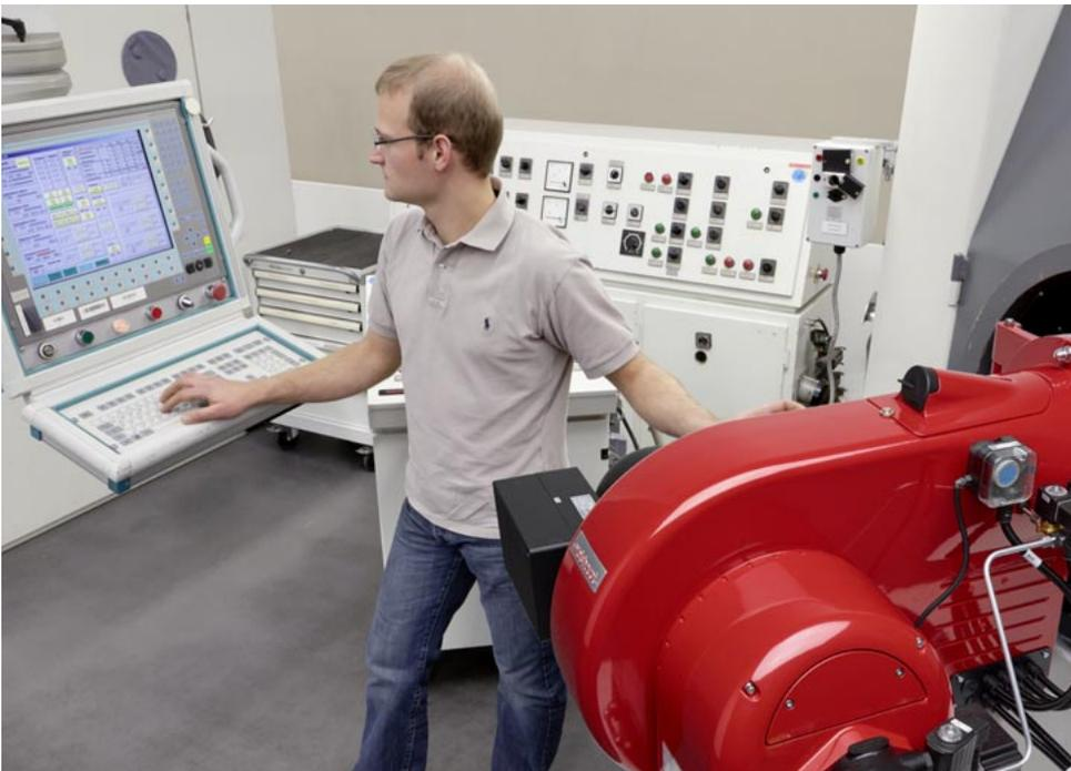
*Am speziellen Prüfstand werden alle Brenner in Schiffsausführung vor Auslieferung umfassend geprüft*
