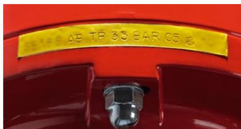
Registrierungs-code am Brennerschwenkflansch
