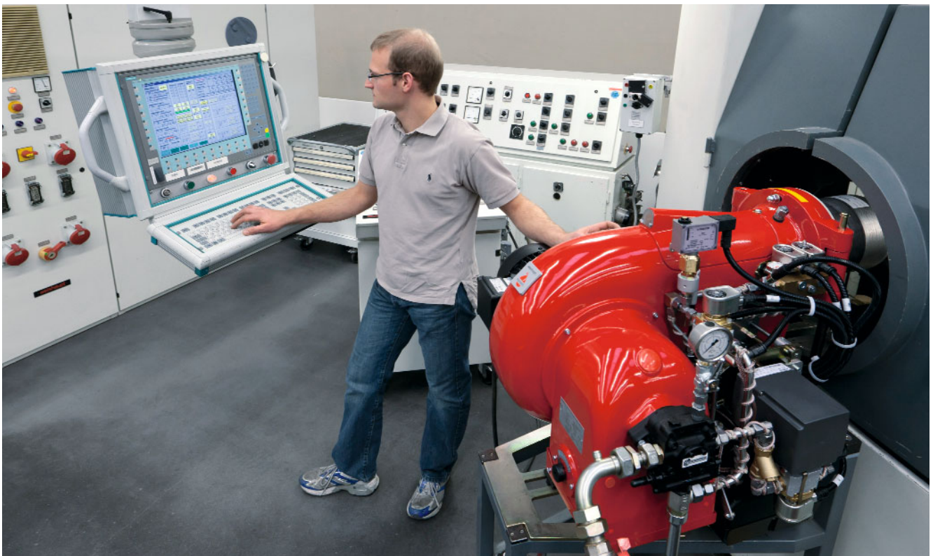
Alle brændere i skibsførelse bliver grundigt testet på specielle prøvestande, inden de forlader fabrikken
