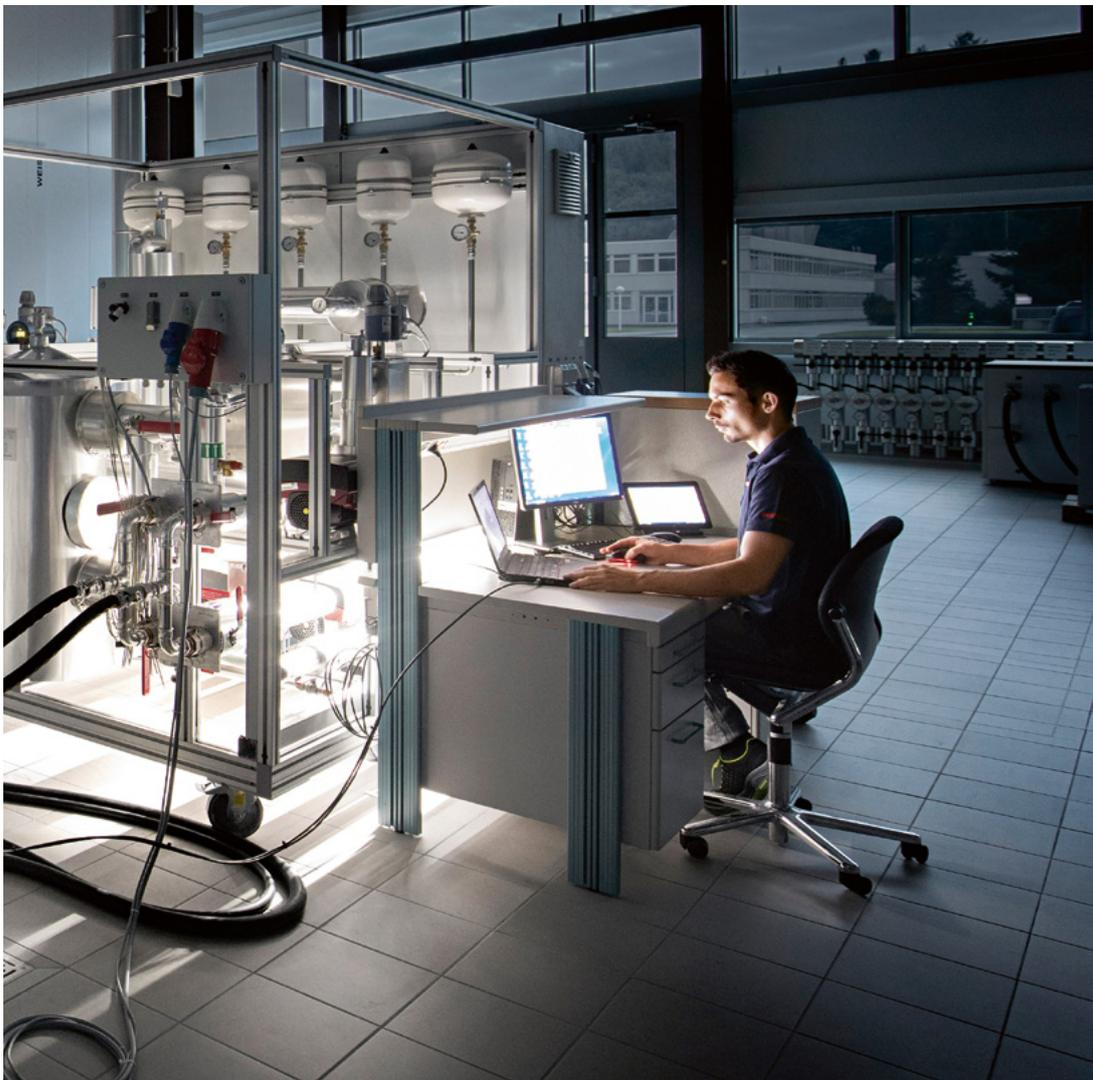
*Prüfstand für Wärmepumpen
