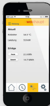
Visualizzazione dei valori effettivi di un impianto solare collegato
