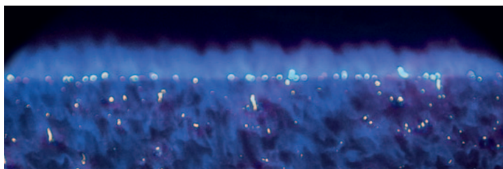
Des températures < 1200°C résultent de la combustion du mélange air-gaz en surface du tissu métallique. Grâce à cette technique de combustion, la formation de NO x thermiques est inhibée.
